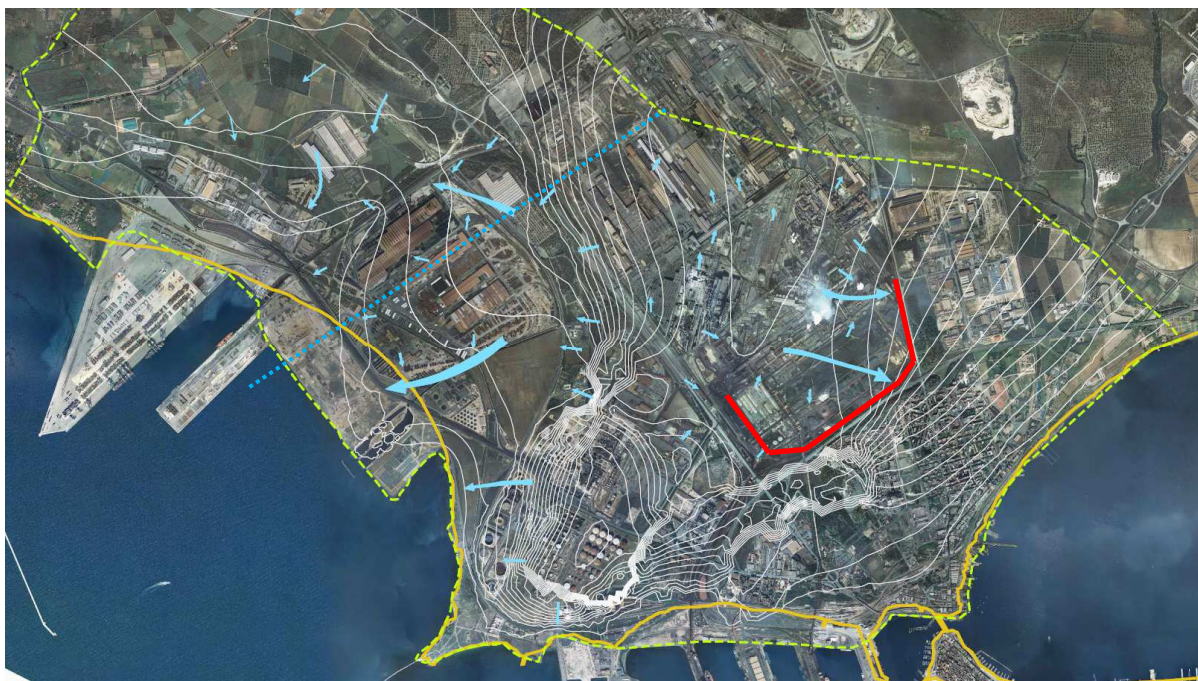
Figura 1 - Elaborazione flusso falda superficiale. Evidenziata in rosso la traccia della barriera idraulica di progetto (fonte: "Studio di fattibilità - Bonifica e messa in sicurezza della falda superficiale dell'intero SIN di Taranto" a cura di Sogesid, 2011)
