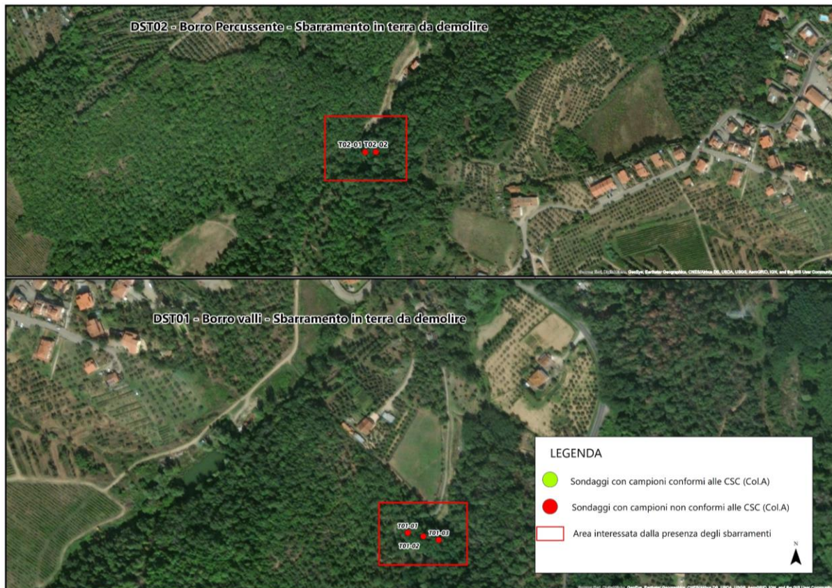
Figura 50 – Sbarramenti in terra (DST01 e DST02): indicazione dei settori di scavo delle terre da destinare al riutilizzo nell'ex discarica di Tegolaia.
