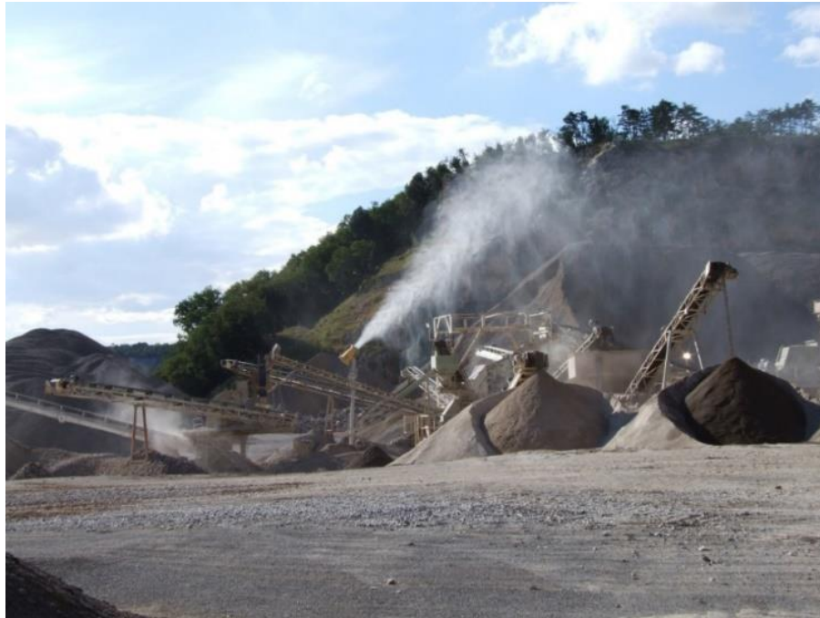
Figura 10- Esempio di nebulizzatore utilizzato nel ciclo di stoccaggio di inerti
