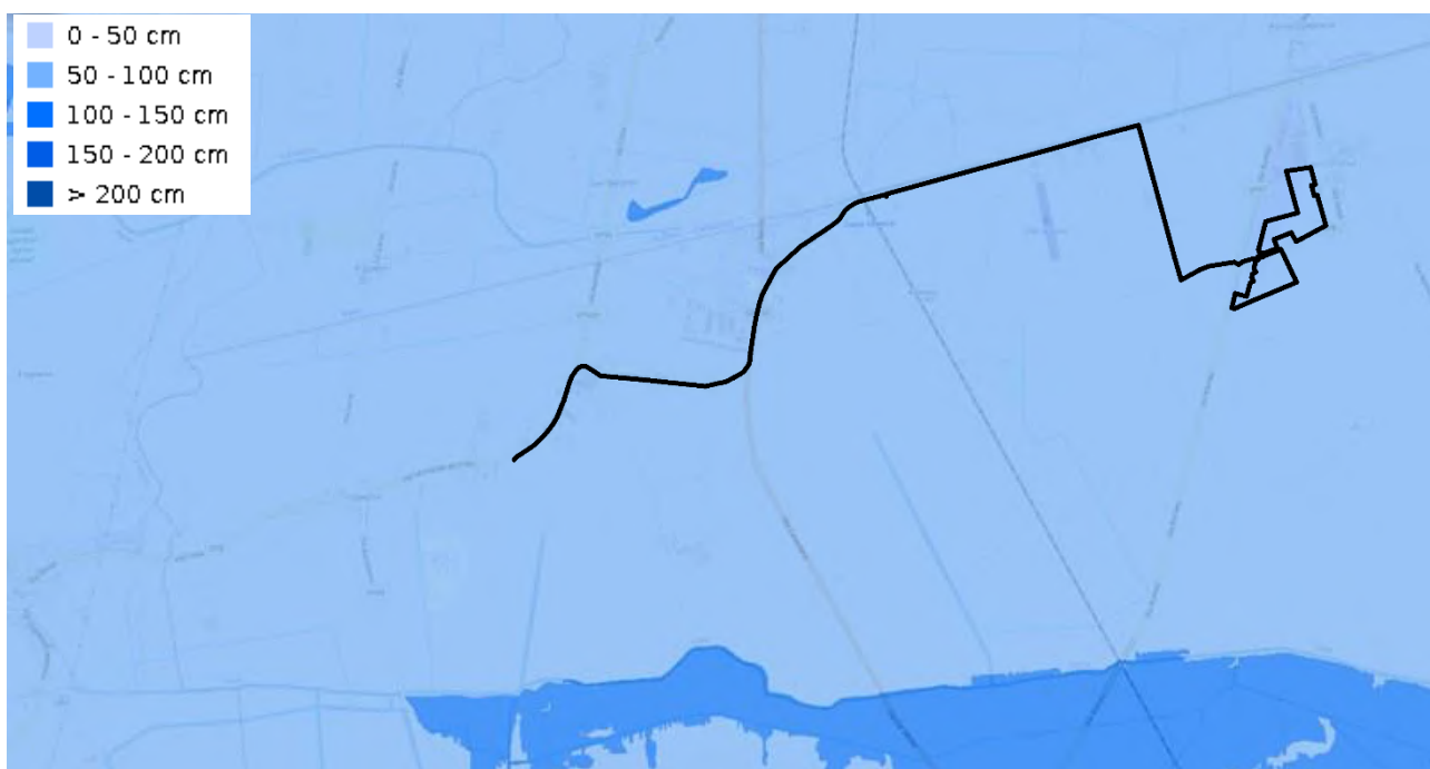
Figura 2-30 – Tirante per TR 100 anni (Fonte web gis SIGMA PGRA 2021/2027 – Autorità di Bacino delle Alpi Orientali)
