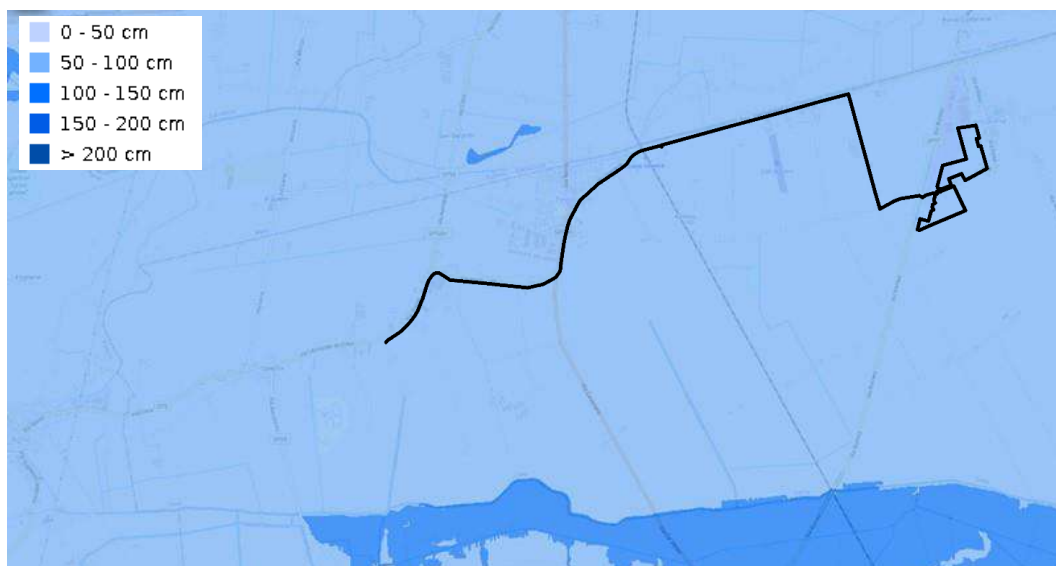
Figura 5-53 – Tirante per TR 100 anni (Fonte web gis SIGMA PGRA 2021/2027 – Autorità di Bacino delle Alpi Orientali)
