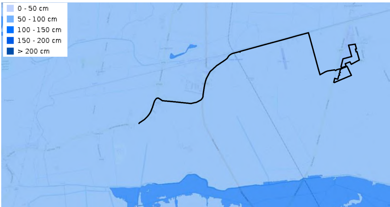
Figura 4-19 – Tirante per TR 100 anni (Fonte web gis SIGMA PGRA 2021/2027 – Autorità di Bacino delle Alpi Orientali)
