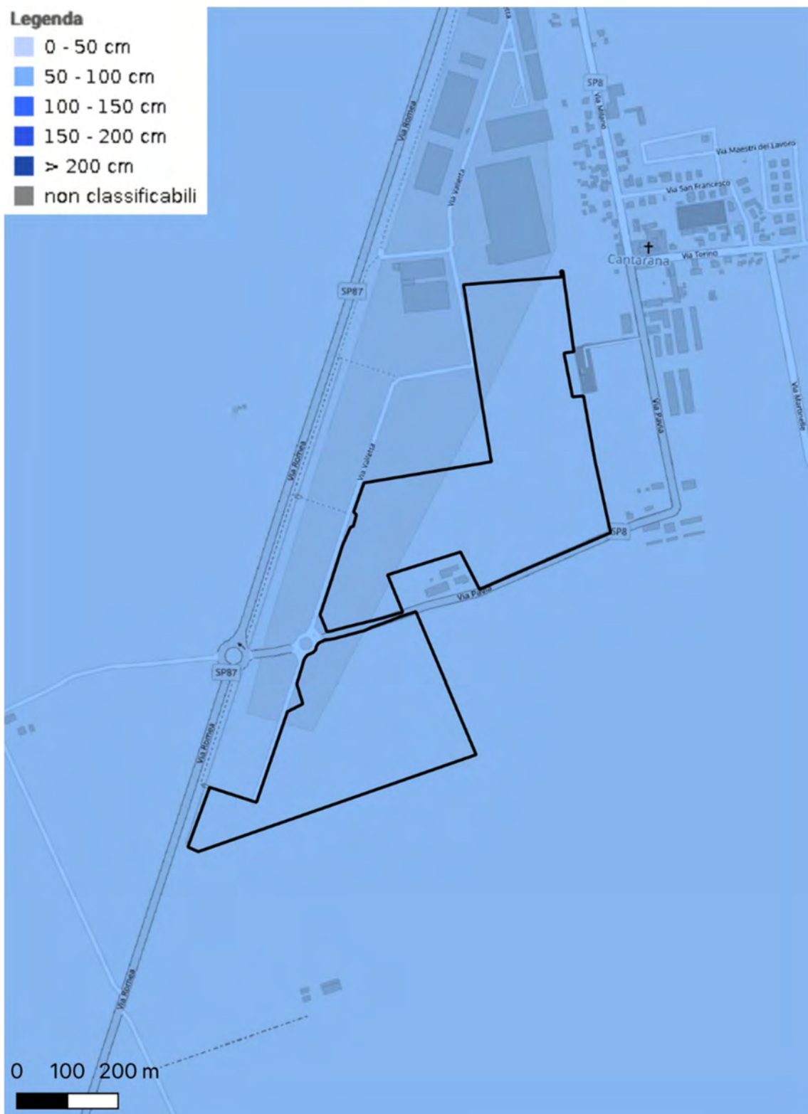
Figura 21 – Mappa dei tiranti di allagamento generati a seguito di un evento con tempo di ritorno di 300 anni con indicazione dell'area di intervento.
