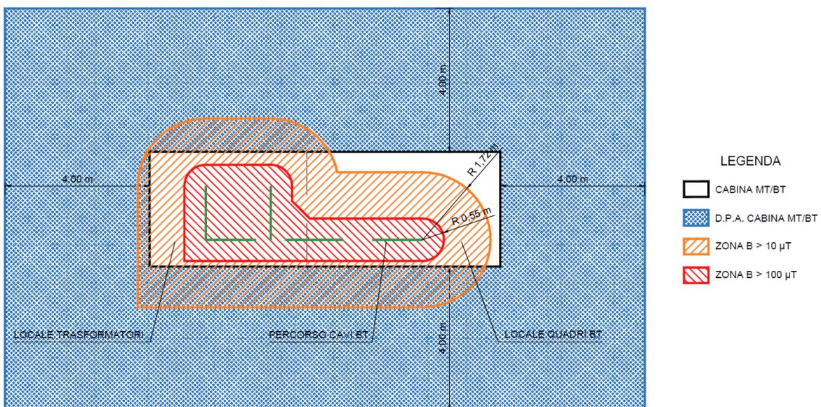
Figura 2 - Zone induzione magnetica CABINA MT/BT 2A-2B-3A-3B
