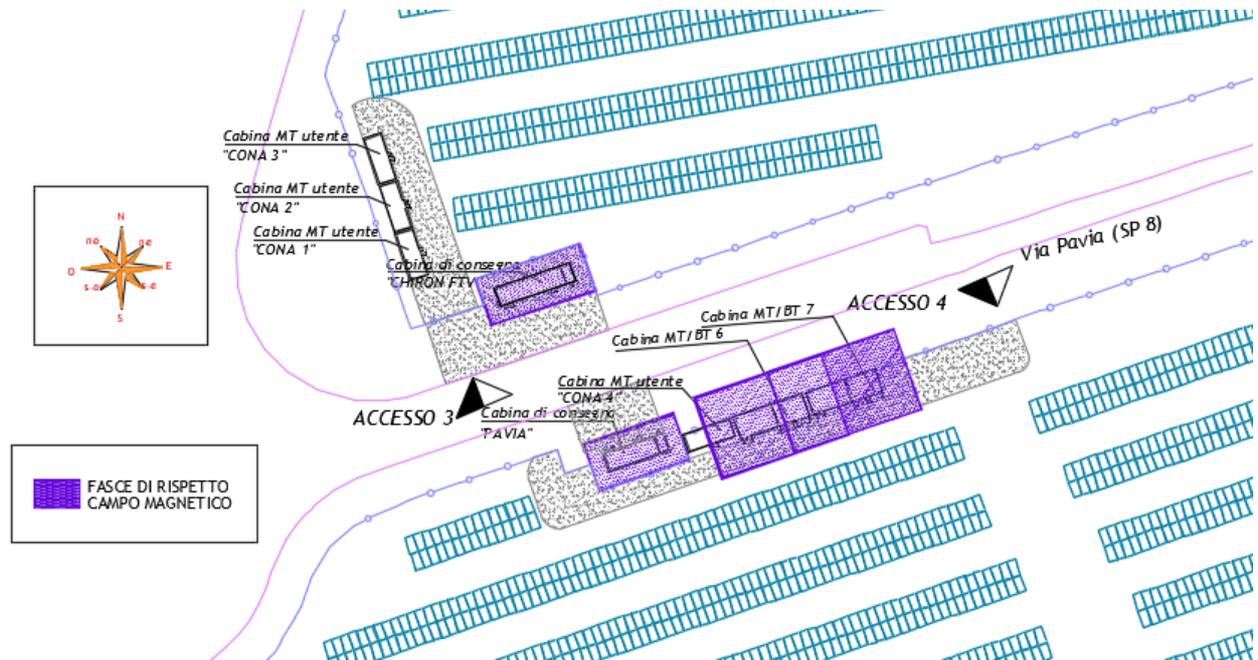
Figura 8:- Particolare area cabine di consegna "CHIRON FTV" e "PAVIA"
