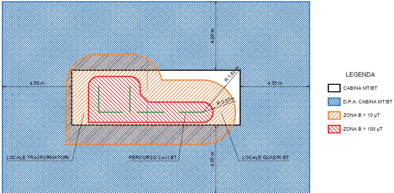
Figura 1 - Zone induzione magnetica CABINA MT/BT 1
