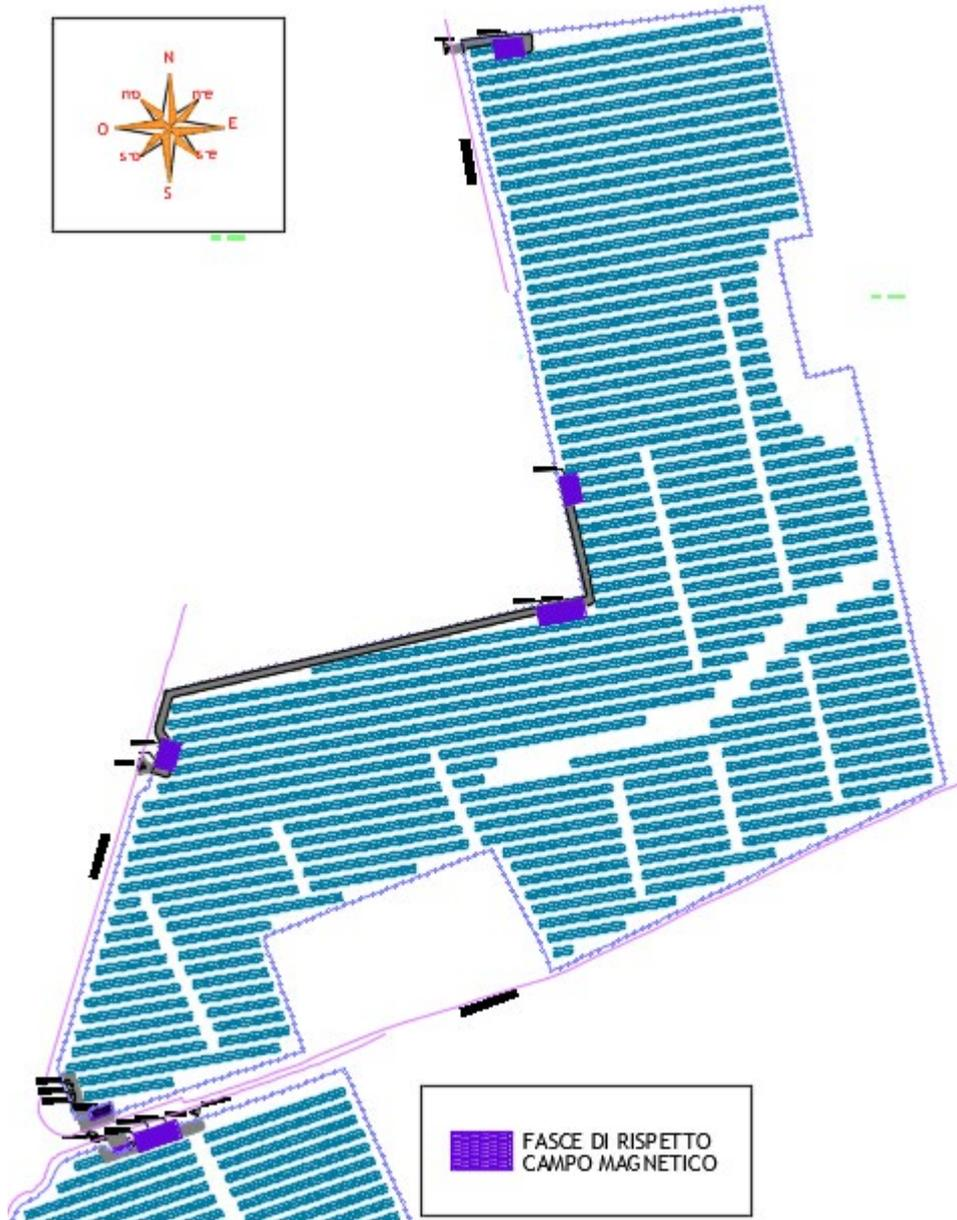
Figura 6 - Planimetria individuazione fasce di rispetto determinate Area Nord
