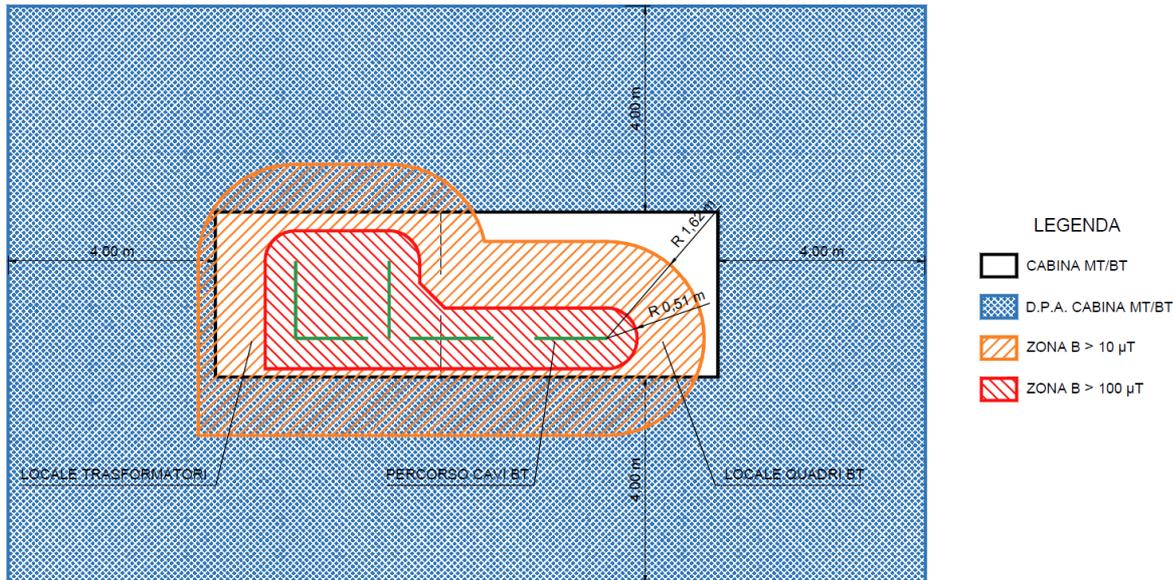
Figura 3 - Zone induzione magnetica CABINA MT/BT 4A-5A
