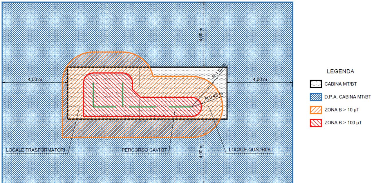
Figura 4 - Zone induzione magnetica CABINA MT/BT 4B-5B
