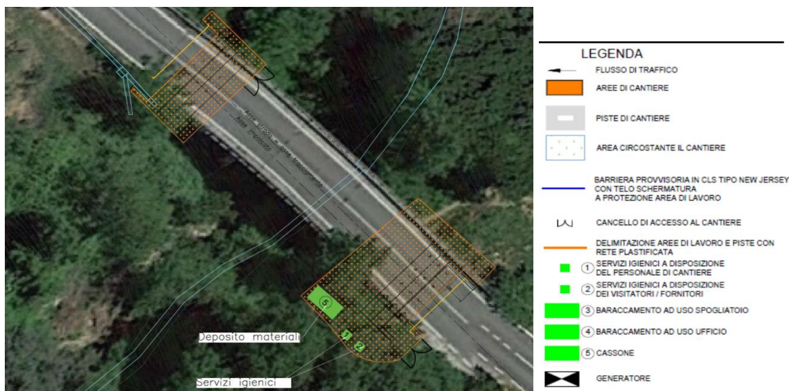
Figura 9: Cantiere Fase 1 - Esecuzione nuove fondazioni al di sotto del ponte esistente (Fonte: Lista di controllo)
