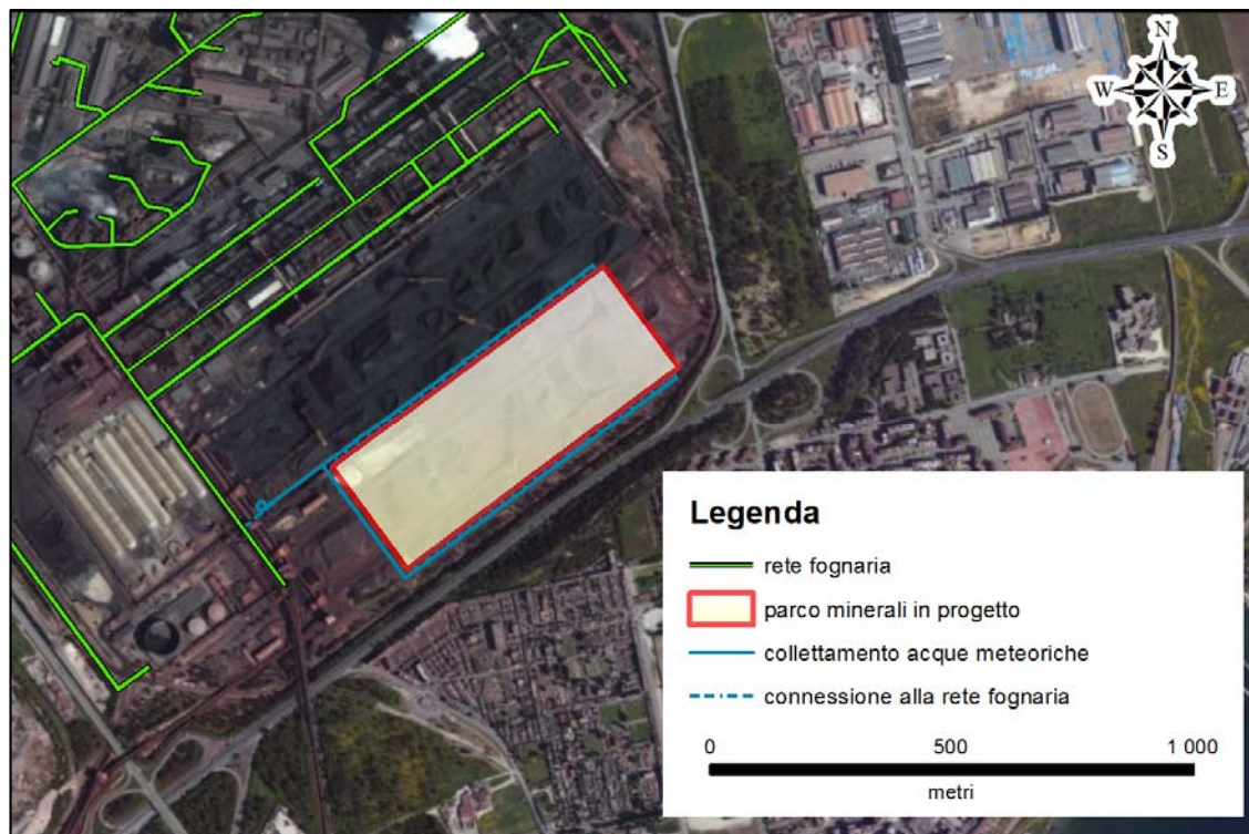
Figura 1 - Area interessata dal progetto di copertura del parco minerali
