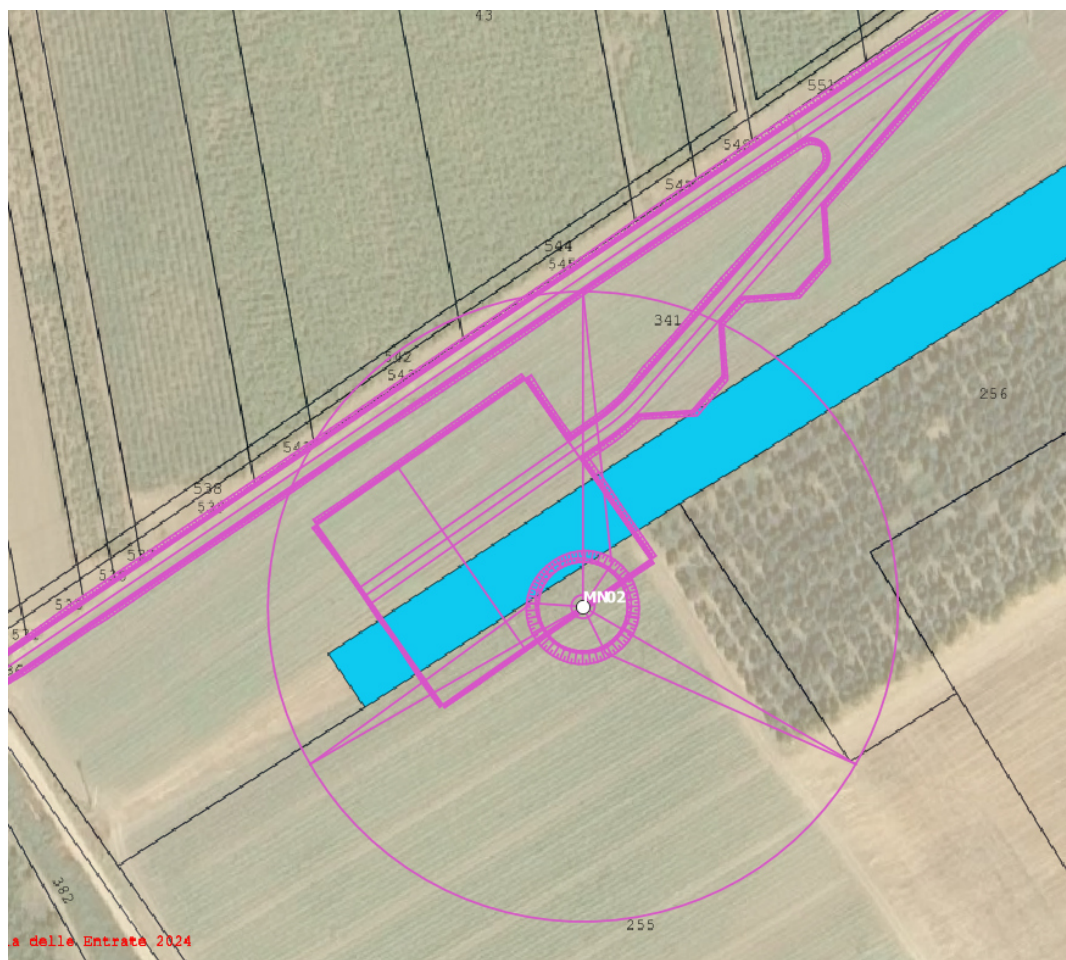
Figura 7-4 Rappresentazione su immagine satellitare, e con catastale, dell'area della piazzola MN02, con aerogeneratore, e relativa via di accesso (Fonte: Agenzia delle Entrate)
