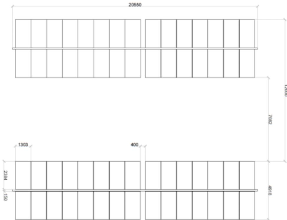
Figura 46. Rappresentazione delle strutture fotovoltaiche utilizzate.
