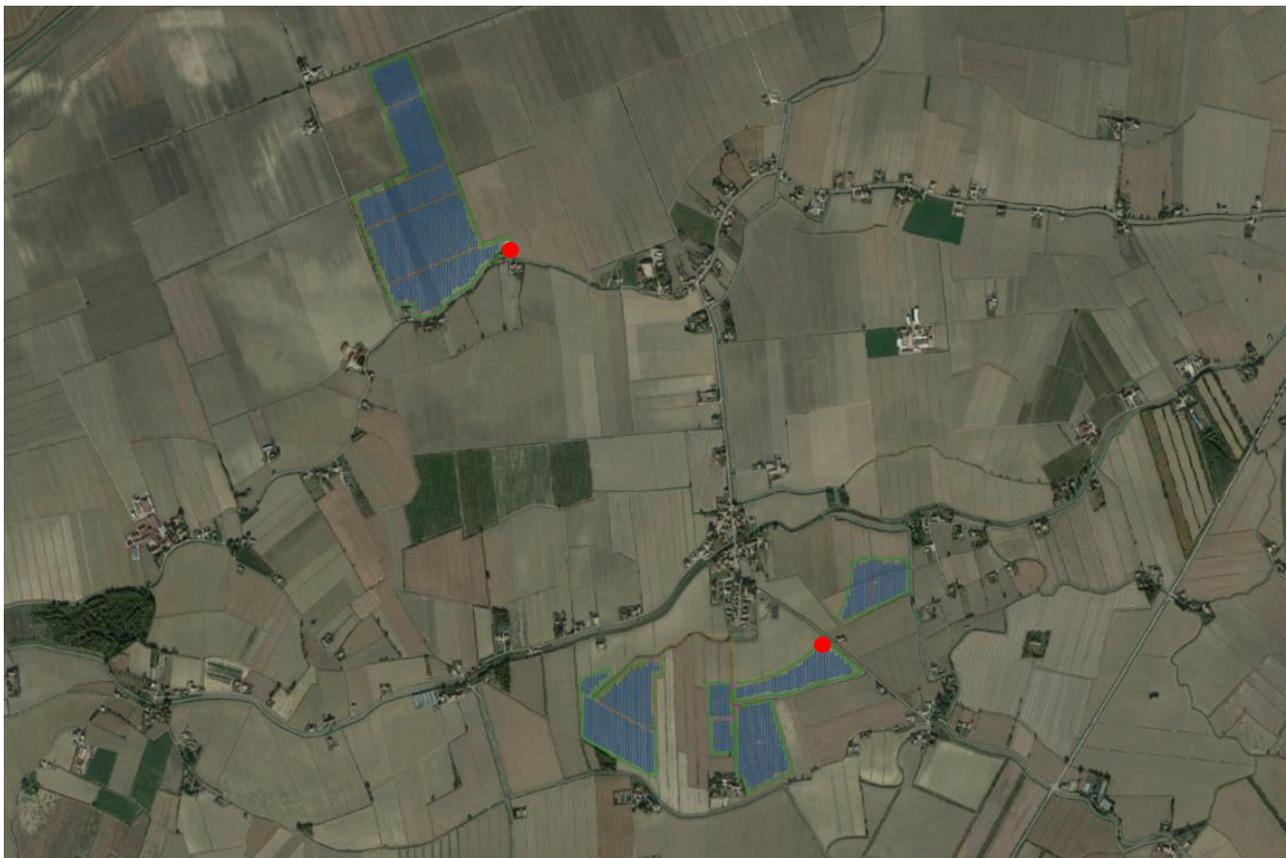
**Figura 61.** Layout generale di impianto con indicate su ortofotocarta: le strutture fotovoltaiche (in blu), le recinzioni di impianto (in verde), le cabine di smistamento AT (puntalino rosso).
