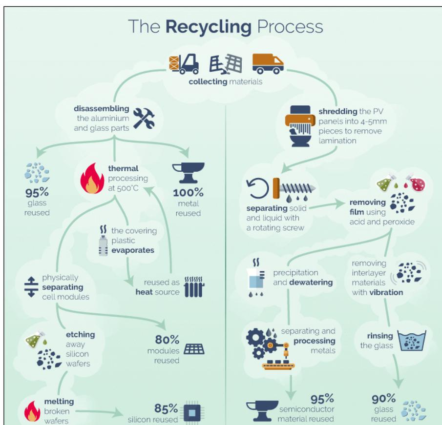
**Figura 80.** Il processo di riciclo dei moduli fotovoltaici a base silicea e dei sottoprodotti della dismissione di impianti fotovoltaici. Fonte: [www.greenmatch.co.uk/blog/2017/10/the-opportunities-of-solar-panel-recycling](http://www.greenmatch.co.uk/blog/2017/10/the-opportunities-of-solar-panel-recycling) (Ultimo accesso: gennaio 2024).
