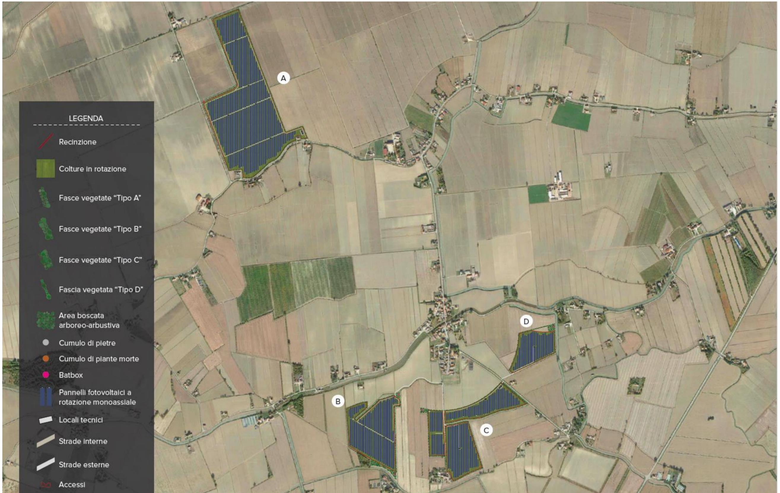
**Figura 115.** Layout relativo alle opere in progetto, con rappresentazione grafica della componente ambientale (colture in rotazione, fasce arboreo-arbustive, micro-habitat per la fauna locale) e della componente tecnologica (pannelli fotovoltaici, strade e locali tecnici) del progetto.
