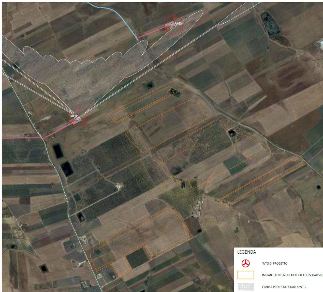
Figura 2.2: Ombra proiettata dall'aerogeneratore in relazione all'impianto fotovoltaico
