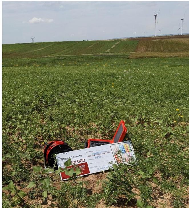
Figura 9-16. Stendimento con apparecchiatura DoReMi.
