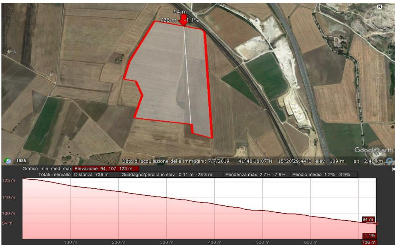
Figura 1-5. Sezione tipo asse S-N (Google Earth).
