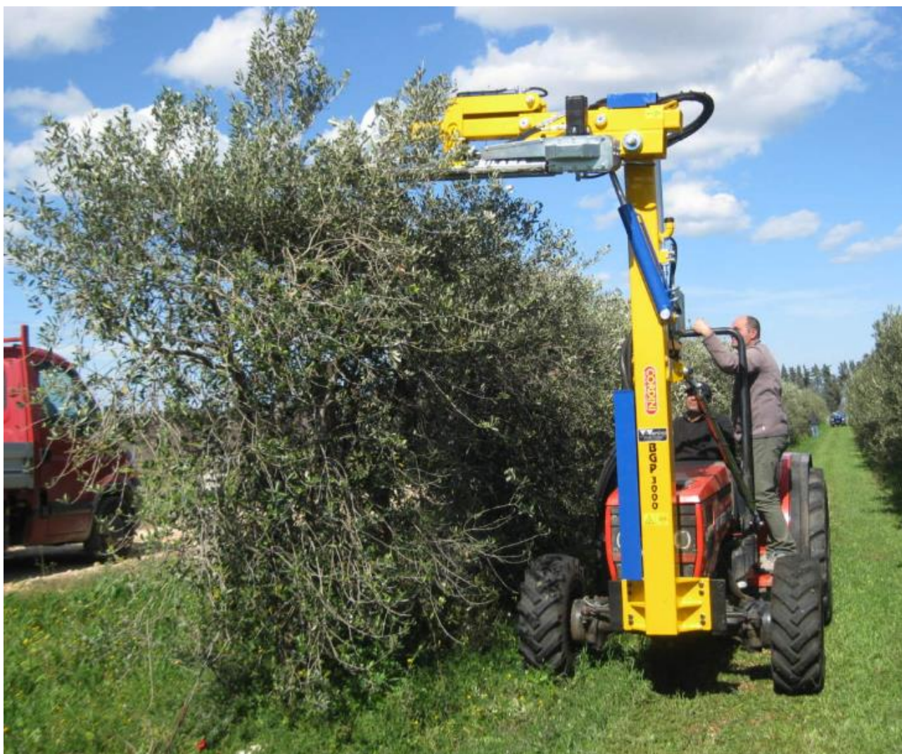
Figura 4-5. Esempio di macchina a lame oscillanti portata da comune trattore per l'esecuzione dell'operazione di topping, necessaria per mantenere l'altezza desiderata delle piante.
