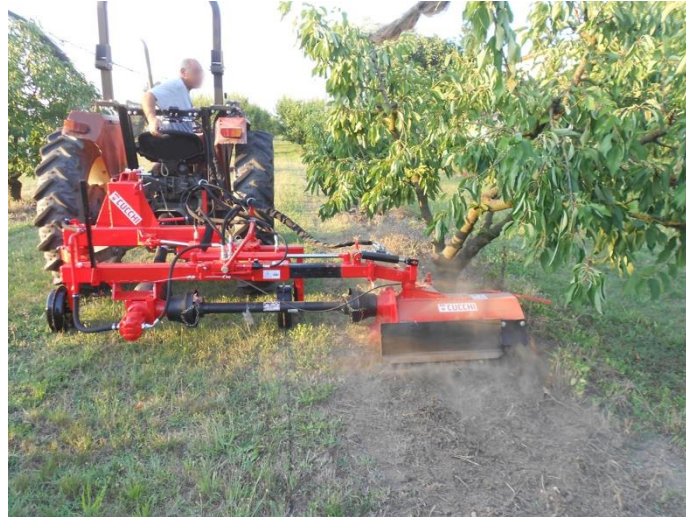
Figura 3-6. Fresatrice interceppo per le lavorazioni sulla fila (Cucchi Macchine Agricole).
