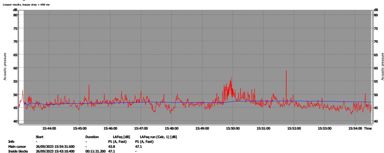
Si considera la sezione delle misure in cui non c'è passaggio di treni né di macchine per poter valutare lo scenario a favore di sicurezza.
