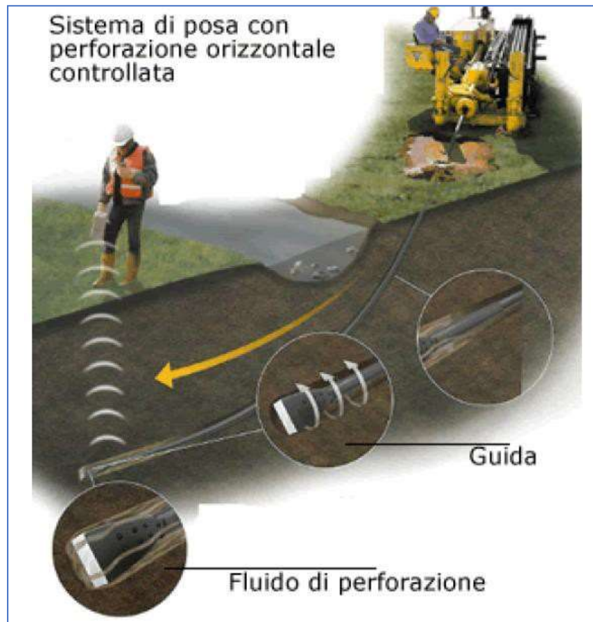
(Fig.5 Trivellazione Orizzontale Teleguidata)
