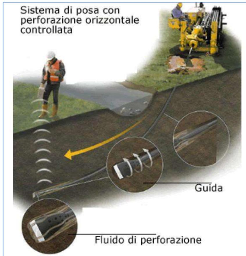
(Fig.5 Trivellazione Orizzontale Teleguidata)
