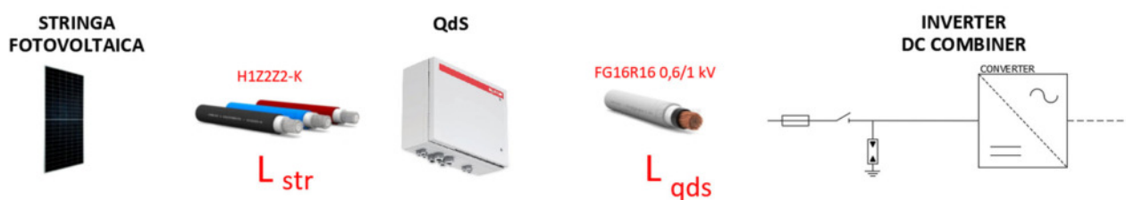
Figura 28. Schematizzazione collegamento elettrico lato DC
