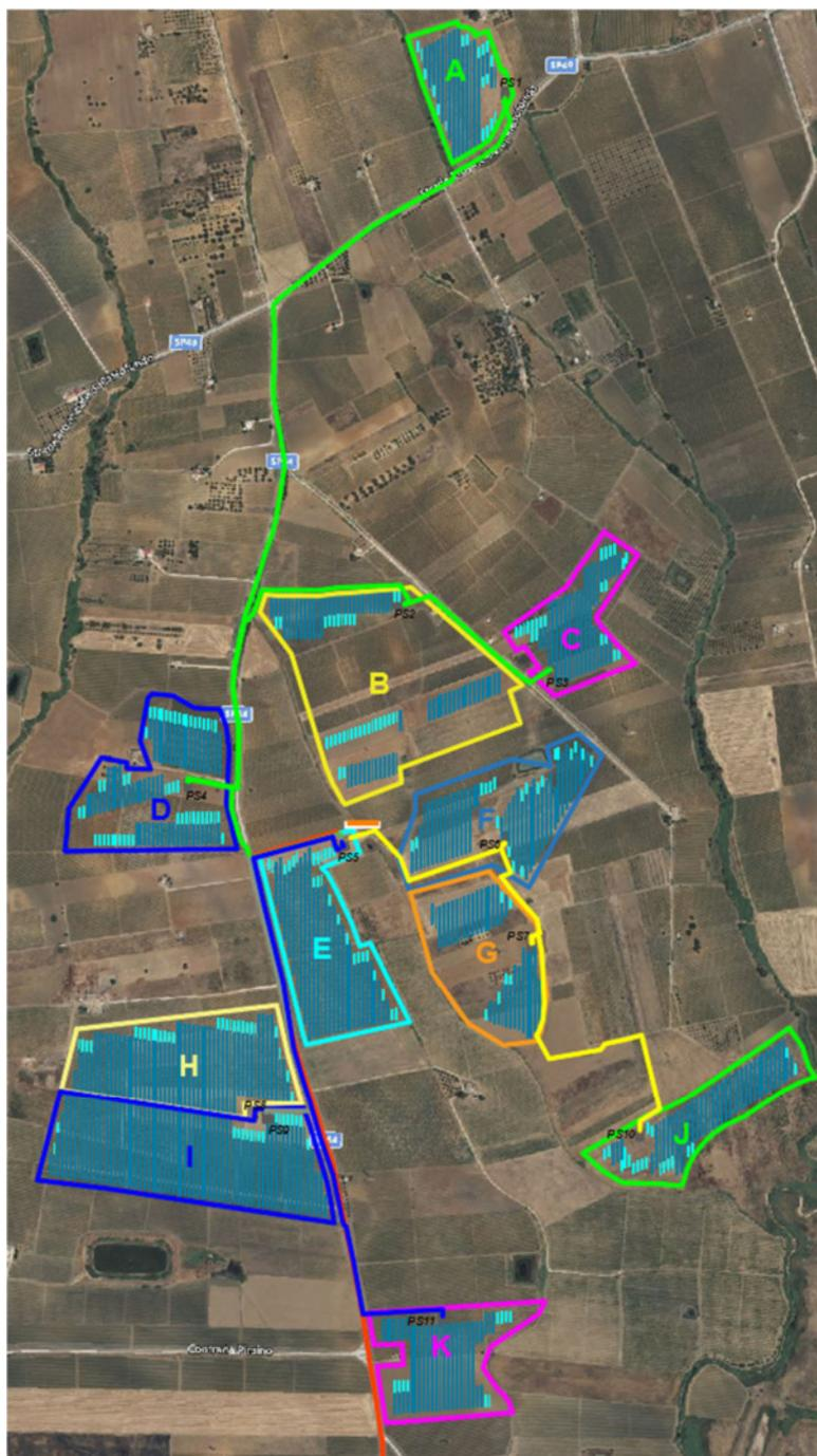
**Figura 2: Layout del campo Agro-fotovoltaico e suddivisione in sottocampi**
