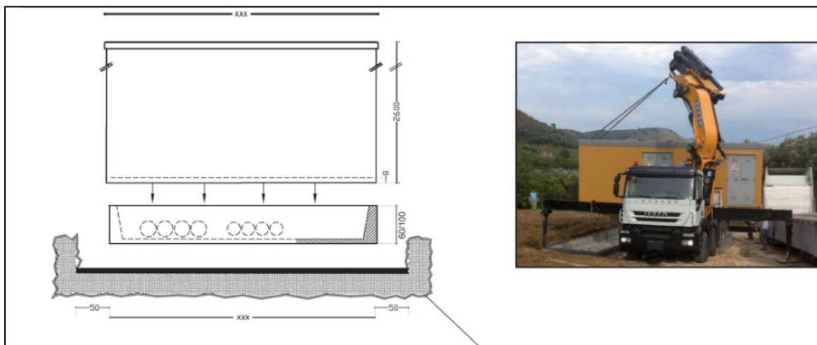
**Figura 9: Esempio monobox cabina di raccolta**
