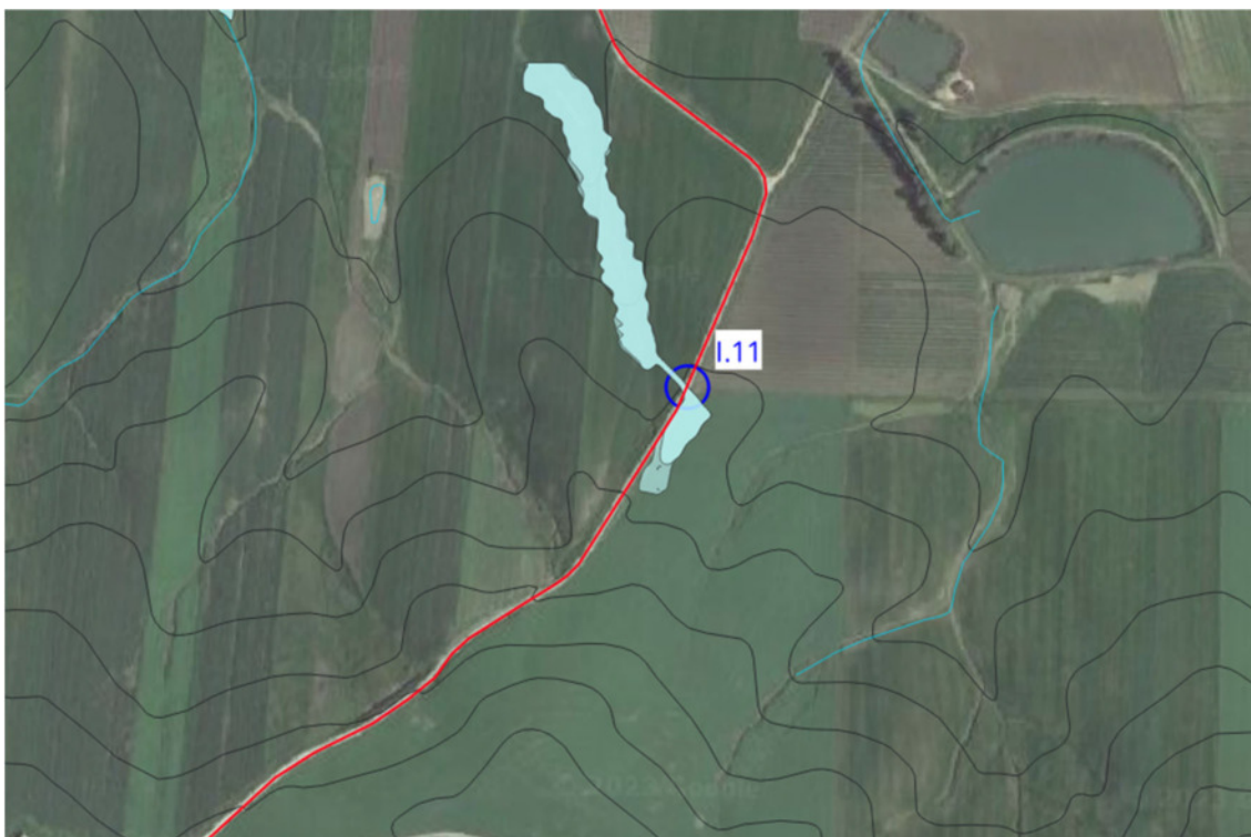
Figura 16 - Rappresentazione dell'area inondabile ottenuta dalla modellazione idraulica bidimensionale per la l.11
