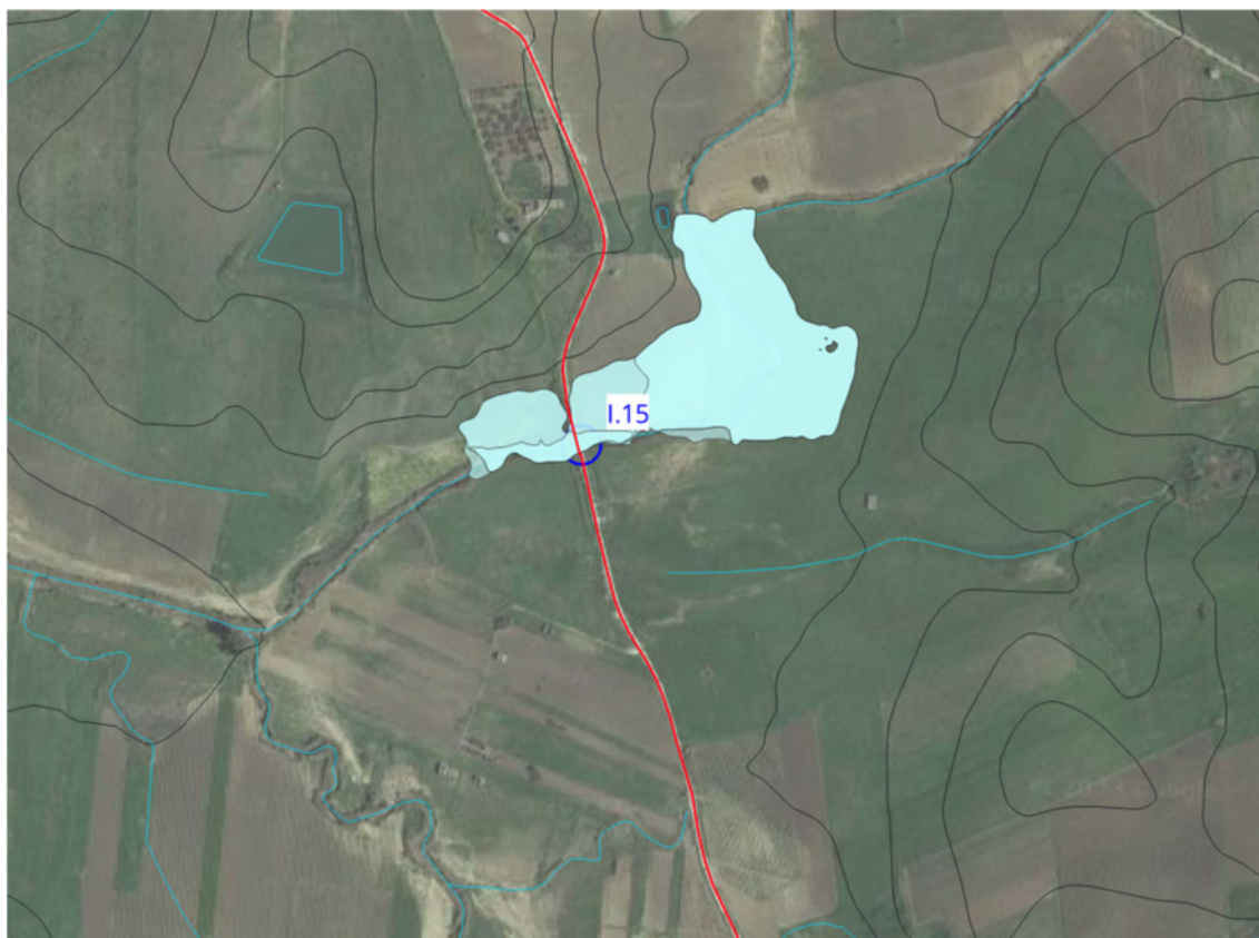
Figura 26 - Rappresentazione dell'area inondabile ottenuta dalla modellazione idraulica bidimensionale per la I.15
