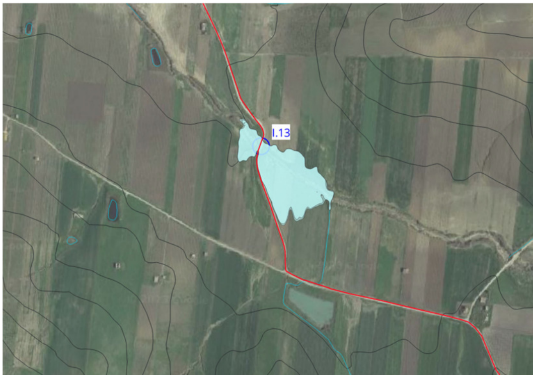
Figura 22 - Rappresentazione dell'area inondabile ottenuta dalla modellazione idraulica bidimensionale per la I.13
