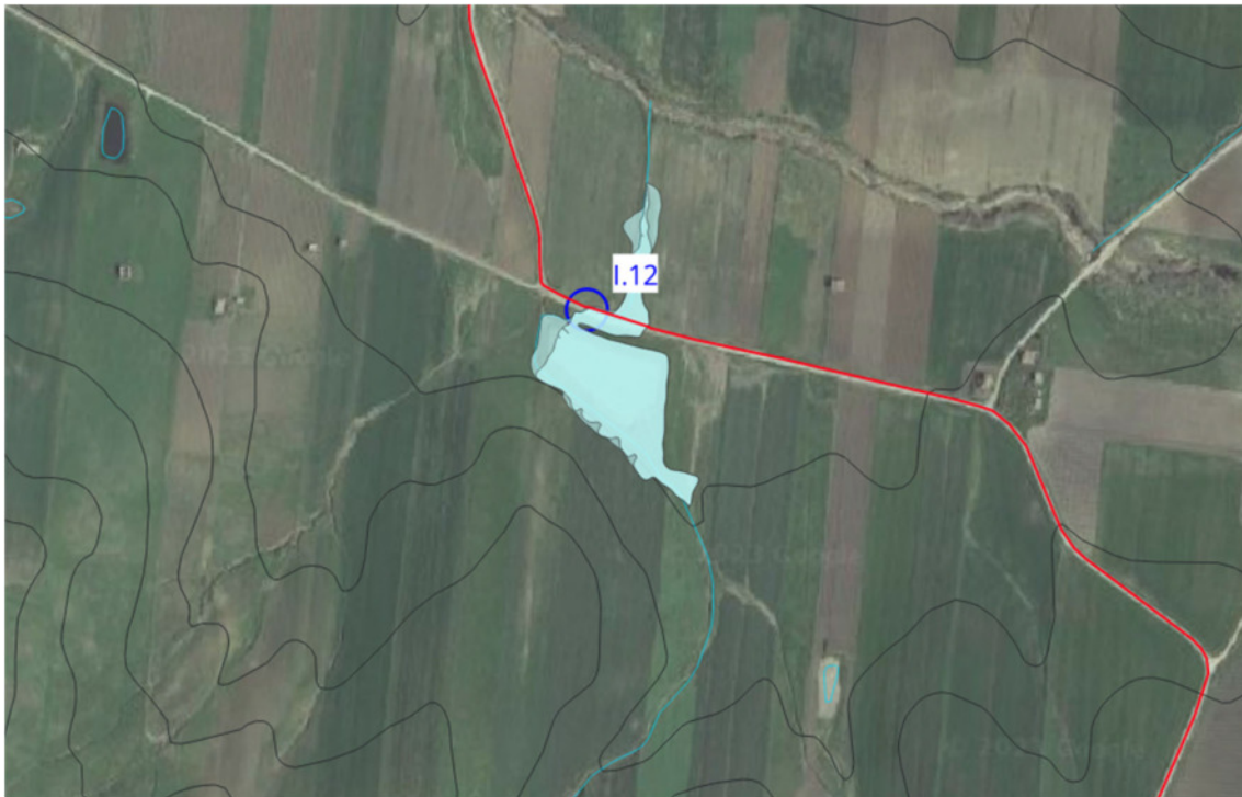
Figura 18 - Rappresentazione dell'area inondabile ottenuta dalla modellazione idraulica bidimensionale per la I.12
