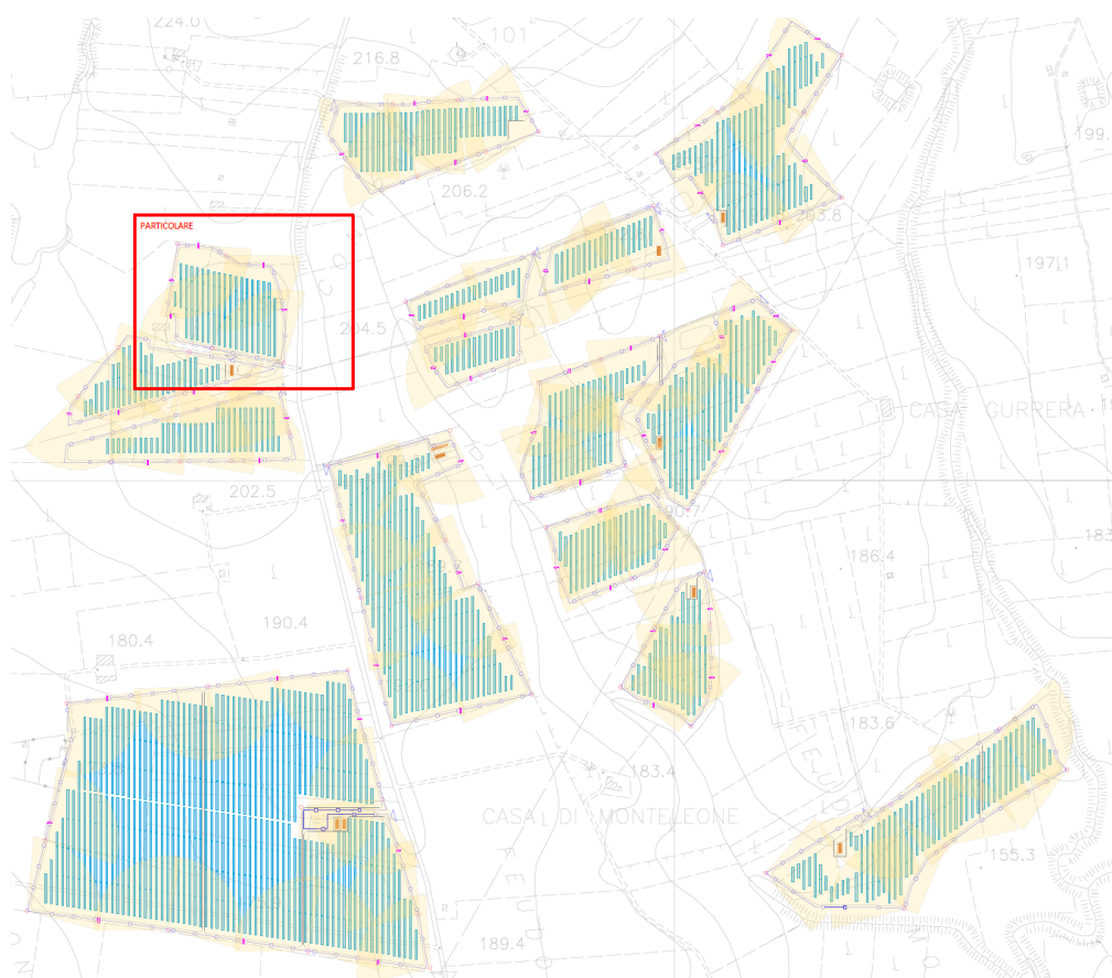
Figura 39 - Particolare dell'area centrale dell'impianto con indicazione del sistema di recinzione, illuminazione e videosorveglianza
