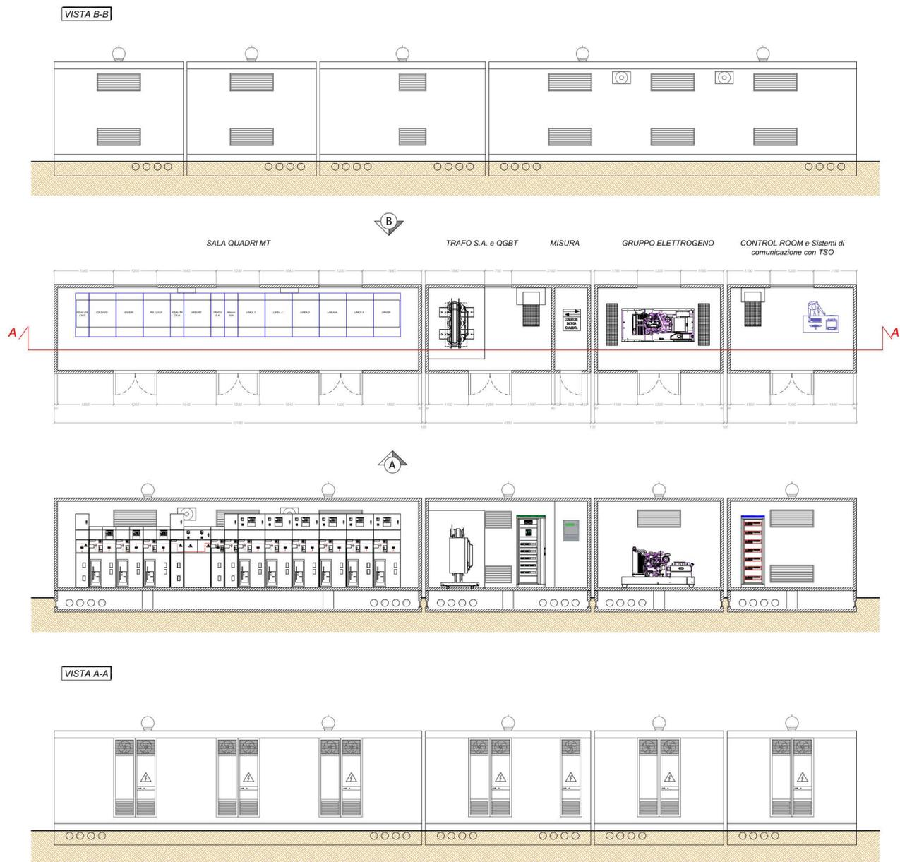
Figura 3.2-1 – Cabina di raccolta e misura
