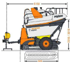
Figura 25 Principali lavorazioni agronomiche e interferenze con strutture tracker (dettaglio su vendemmiatrice, in basso a destra, con relativi parametri dimensionali)
