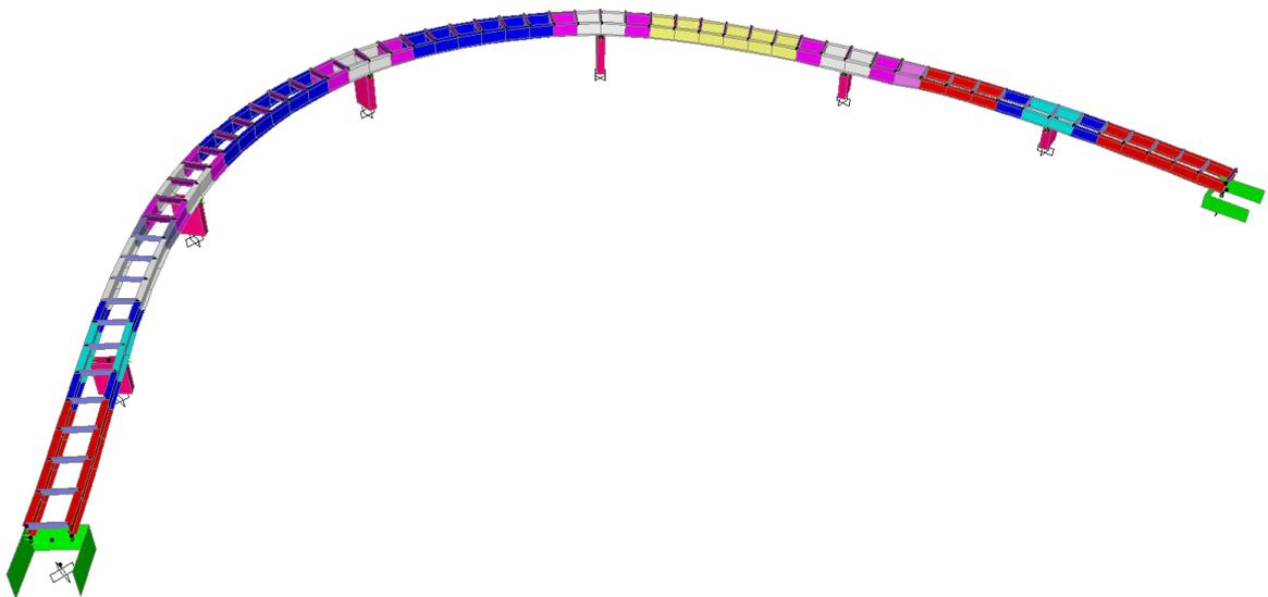
L'analisi modale è stata condotta esclusivamente nella III Fase inserendo gli spettri di risposta elastici in termini di accelerazioni per la definizione delle sollecitazioni sismiche.
