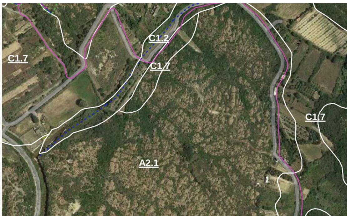
Figura 11-Stralcio Mappa di impianto FV sovrapposto a Carta litologica RAS (1:25.000) e ortofoto 2016- Particolare di collegamento linea di distribuzione tra Settore A e Settore B dell'impianto. Legenda: tratto bianco limite aree litologiche- tratto blu discontinuo fiume, tratto rosa linee di connessione CMT
