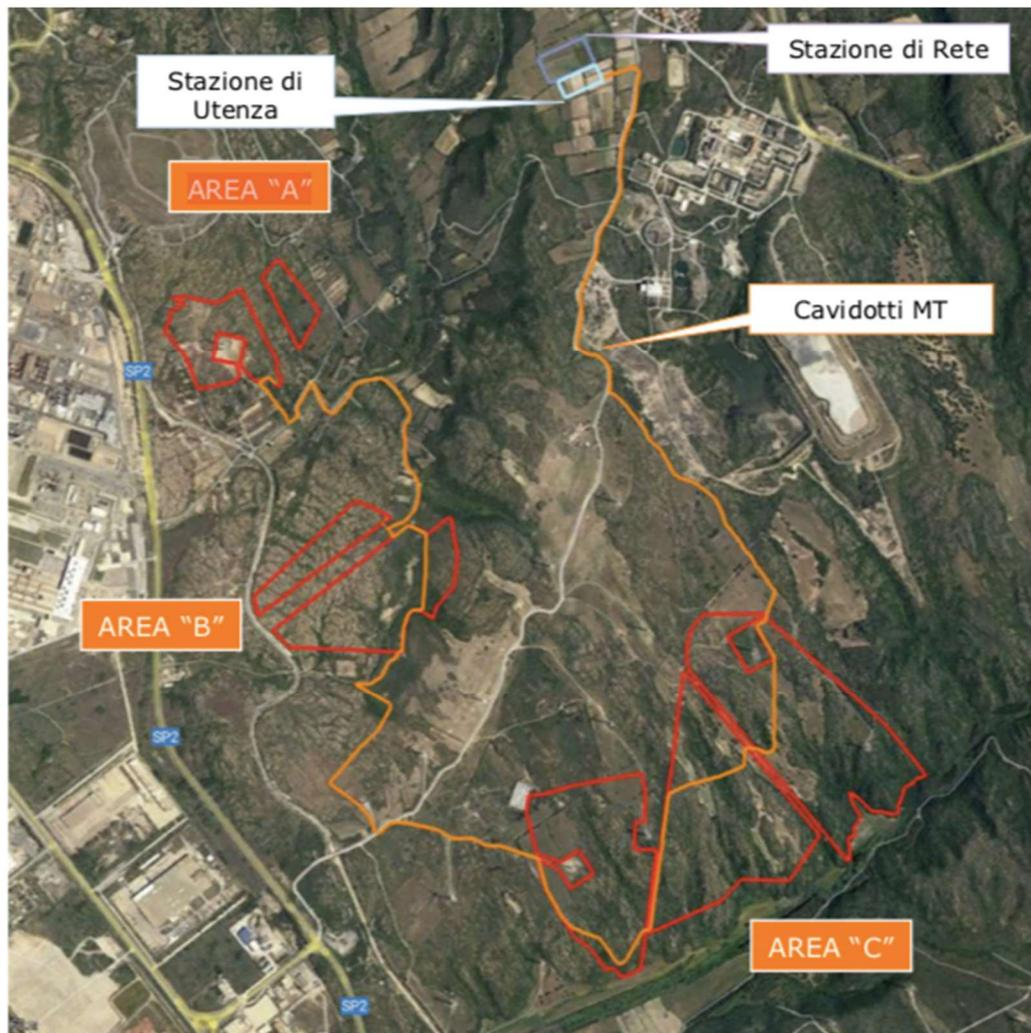
Figura 4- Planimetria Generale dell'area di proprietà della società proponente (tratto rosso) che include l'Impianto e sue opere di connessione (tratto arancione) su ortofoto 2016
