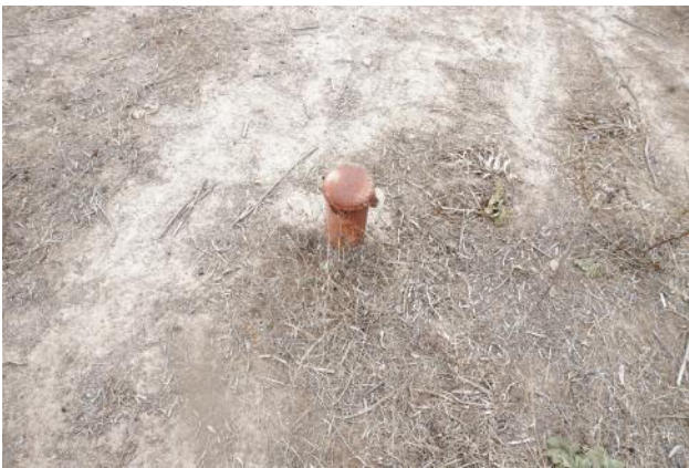
Foto 25 - Particolare del piezometro PS09.
