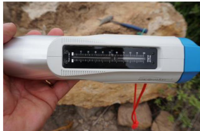
Foto 22 – Misure di resistenza a compressione attraverso Sclerometro per Roccia GeoHammer in località Su Medadeddu.
