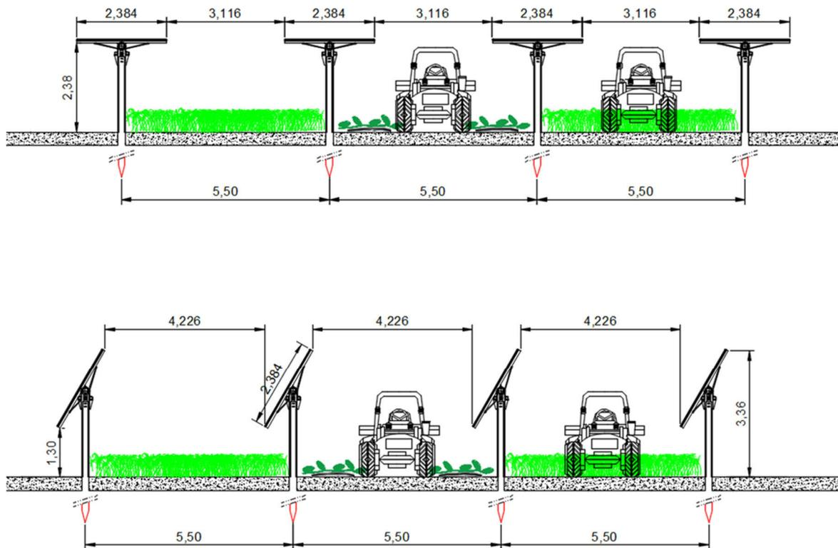
Fig.2: Rappresentazione della struttura di sostegno del modulo agrivoltaico avanzato
