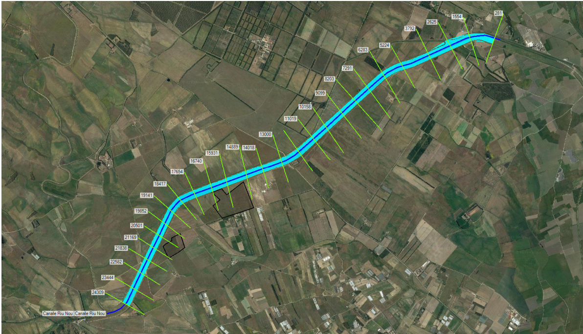
Figura 13: Simulazione idraulica tempo di ritorno 500 anni
