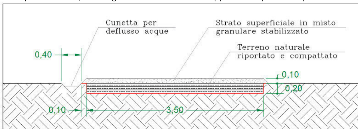
Figura 2 – Sezione trasversale strada con indicazione della cunetta
