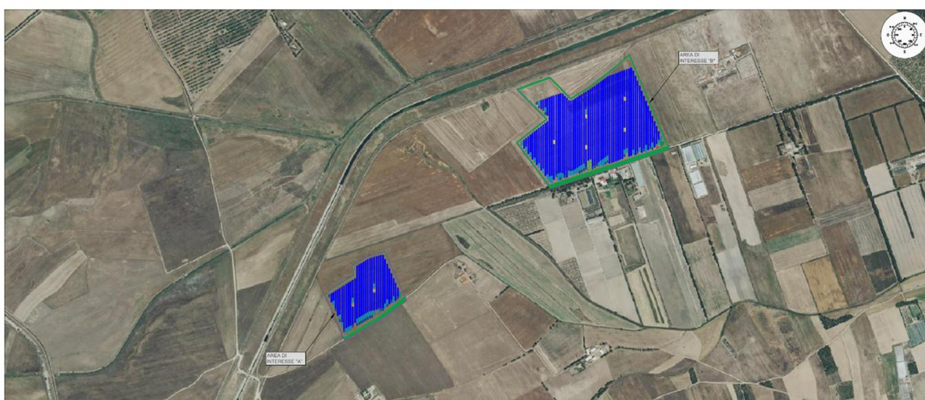
La realizzazione dell'impianto sarà eseguita mediante l'installazione di moduli fotovoltaici su strutture (Tracker) ad inseguimento monoassiale installate a terra tramite infissione di pali; i tracker hanno asse di rotazione disposto in direzione N-S e ruotano di +/- 60° in direzione E-O.
