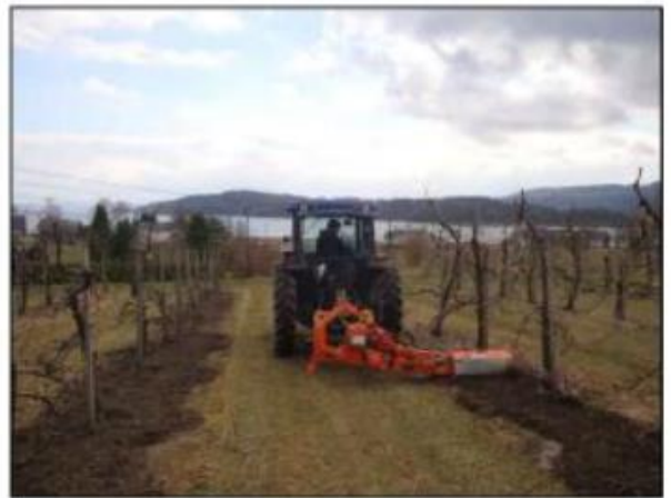
Esempio di fresatrice interceppo per le lavorazioni sulla fila
