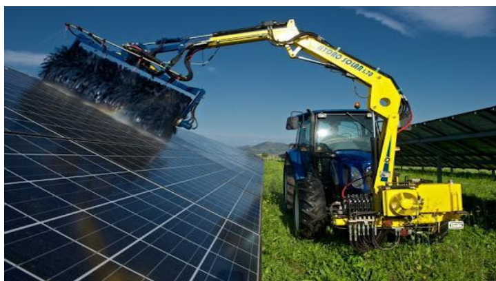
Figura 27 – Macchina per la pulizia dei pannelli fotovoltaici
