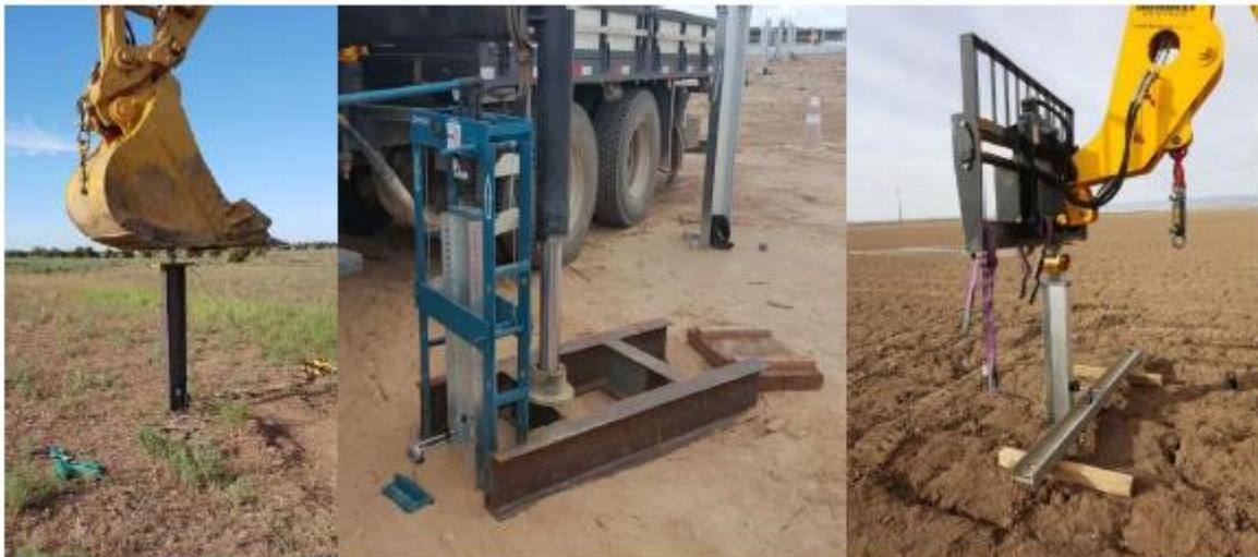
Nei risultati della relazione PULL OUT TEST (depositato nel procedimento) è emerso che per resistere a venti oltre 150 km/h è necessario una trave profilo W 8x 10 nei settori centrali e W8x15 nei settori perimetrali piantati da una profondità da 2,5 a 3 m a seconda della zona.
