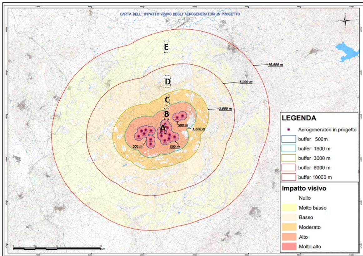
Figura 29 – Impatto visivo degli aerogeneratori in progetto
