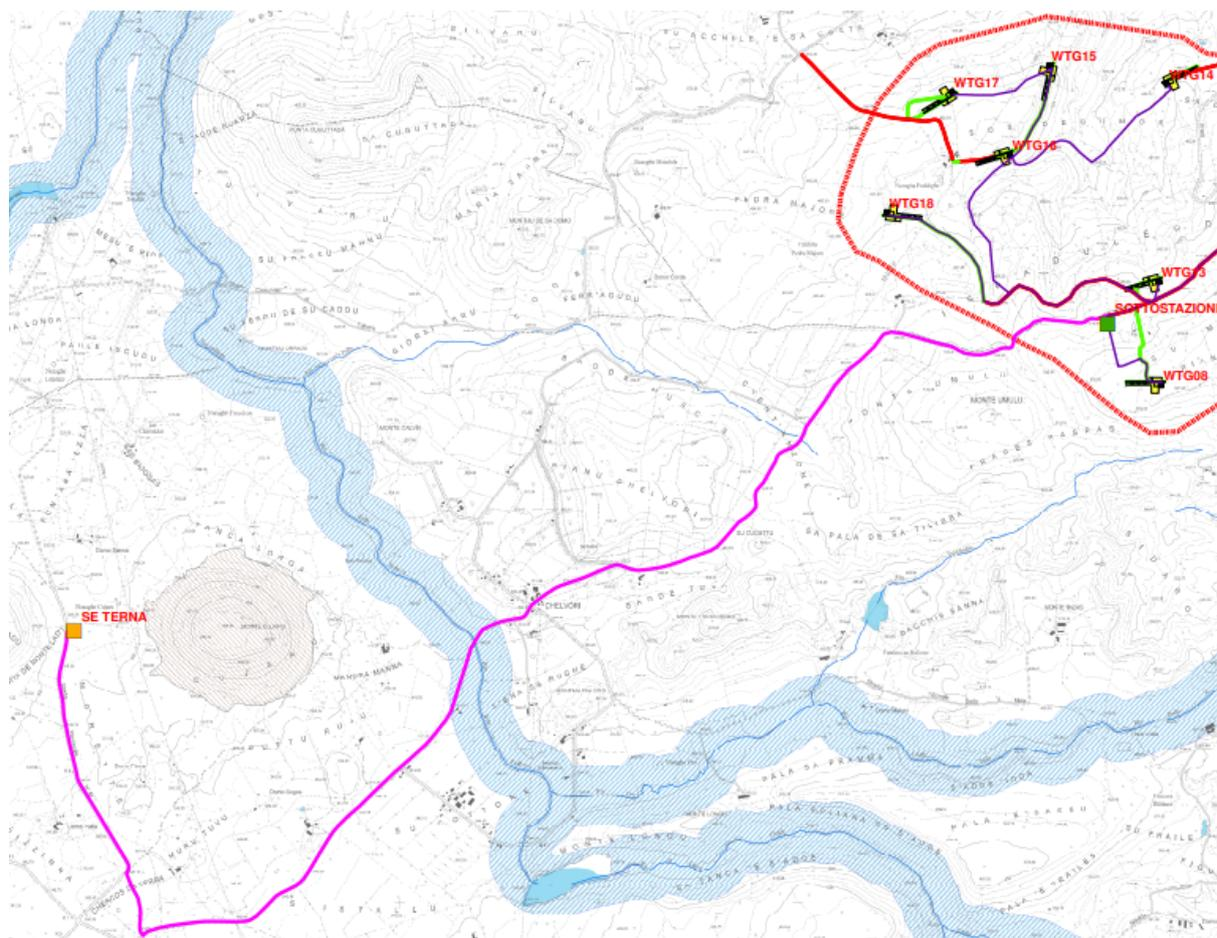
Figura 9 – Tratto del cavidotto di connessione lungo la strada che attraversa il Riu Mannu
