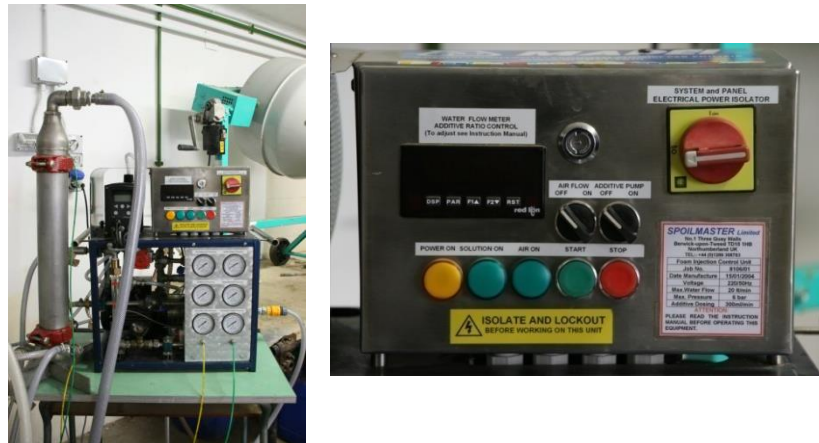
Figura 2.1 - Generatore di schiuma utilizzato presso il laboratorio TUSC del DITAG. Unità di generazione di schiuma (sinistra). Pannello di controllo dei parametri di generazione schiuma (destra).
