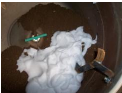
Il terreno viene miscelato con l'agente schiumogeno nel mixer
