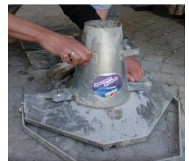
Il cono viene sollevato e l'abbassamento allo slump misurato
