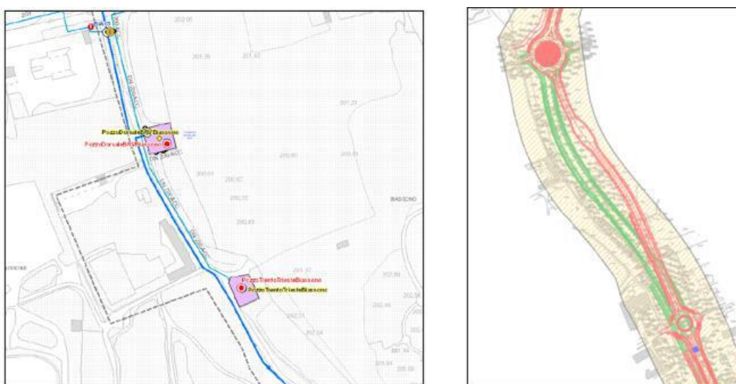
Figura 44 – Ottimizzazione progettuale C18 (in verde PD – in rosso PE) – A sinistra i pozzi
