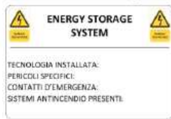
Esempio di scheda descrittiva d'impianto (rif. "Rischi connessi con lo stoccaggio di sistemi di accumulo Litio-ione" e NFPA 855)
