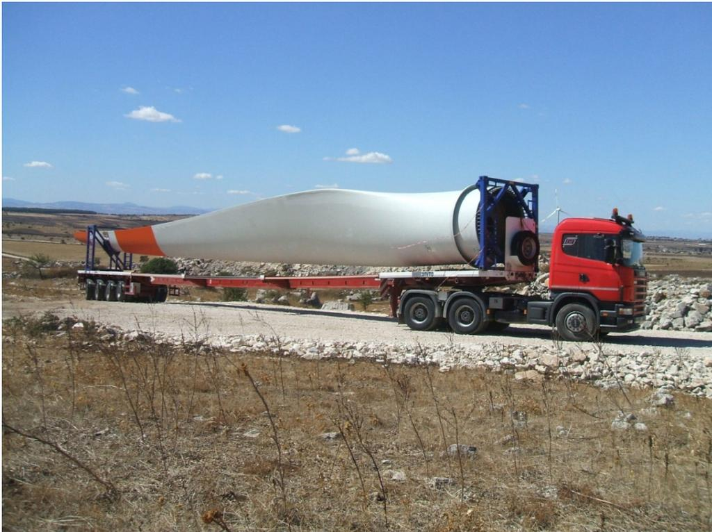
Figura 1 | Trasporto componenti - blade eolica
