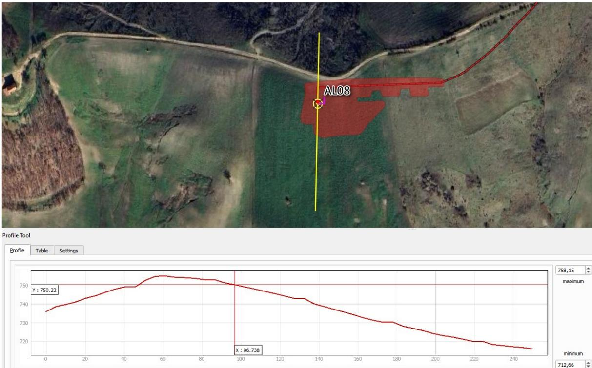
L'area di sedime dell'aerogeneratore AL\_08 è ubicata in località Serra Baldassarre, sulla sommità di una dorsale che separa due torrenti secondari tributari del Fiume Bradano, alla quota di 750,0 metri s.l.m.
