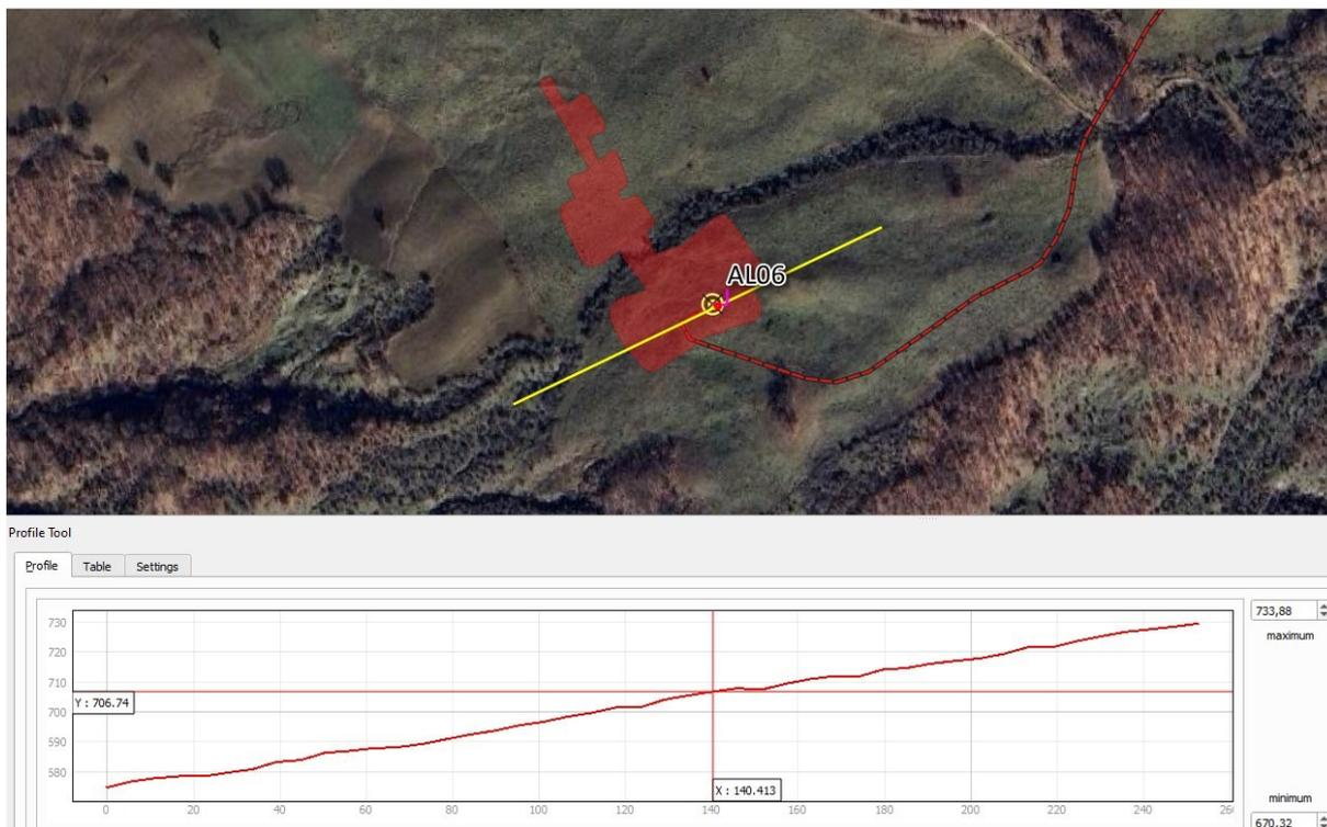
L'area di sedime dell'aerogeneratore AL\_06 a mezza costa di un versante con pendenza superiori ai 14°, sito in sinistra idrografica del fosso Valle di Monticchio, alla quota di 705,0 metri s.l.m.
