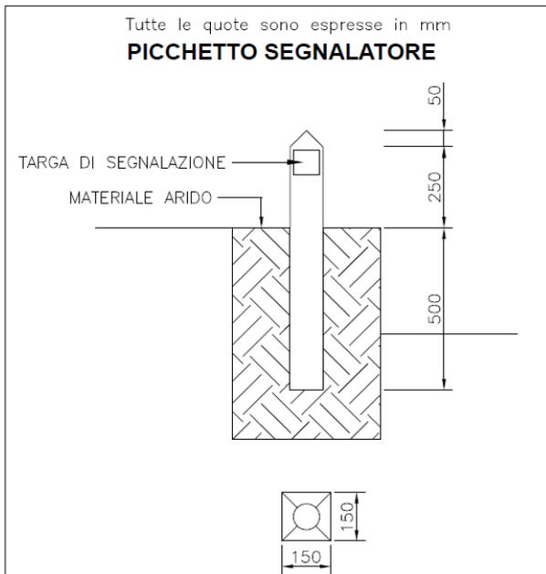
**Figura 5.2.5:** Sezione tipica del picchetto segnalatore
