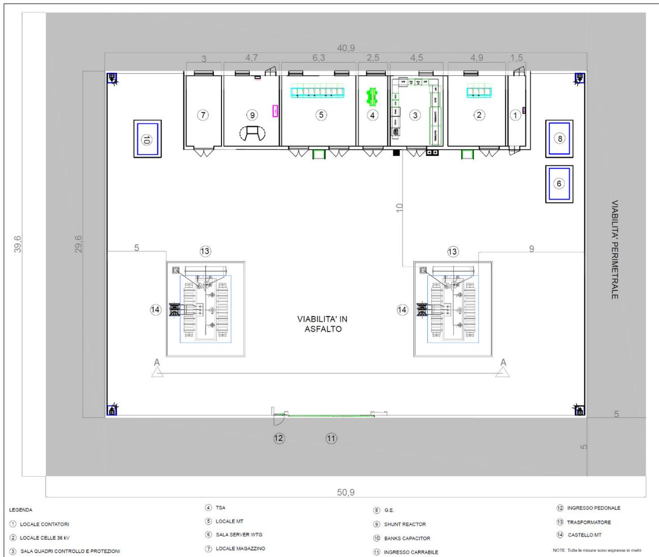
**Figura 3.5.2:** Planimetria elettromeccanica della SEU 36/33 kV
