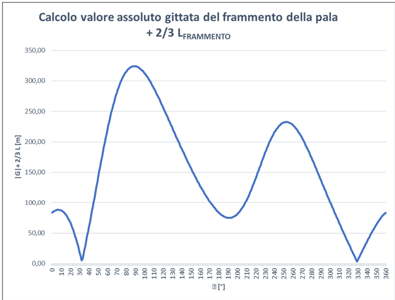
Figura 8.2: Grafico del valore assoluto della gittata del frammento della pala di lunghezza 5 \text{ m} + \frac{2}{3} L_{\text{FRAMMENTO}}
