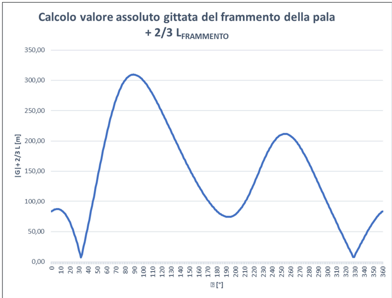
Figura 8.4: Grafico del valore assoluto della gittata del frammento della pala di lunghezza 10\text{ m} + \frac{2}{3} L_{\text{FRAMMENTO}}
