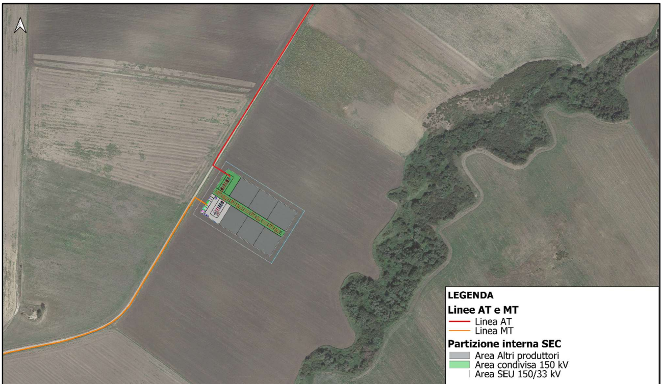
Figura 2.3.4.1: Area Sottostazione di condivisione Melfi
