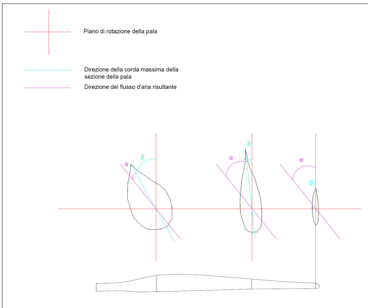
Figura 3.1.2.1: Rappresentazione grafica degli angoli di pitch e di attacco (il disegno non è da intendersi in scala)
