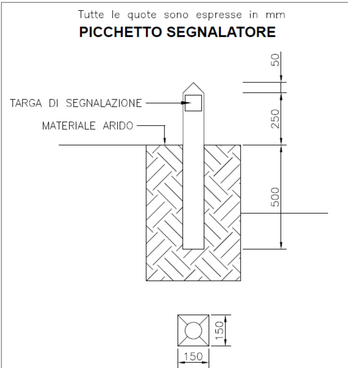
Figura 8.4: Sezione tipica del picchetto segnalatore
