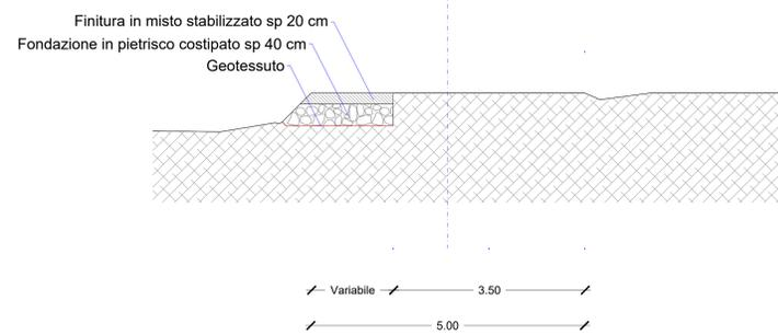
SEZIONE TIPO-ADEGUAMENTO VIABILITA' ESISTENTE\_SCALA 1:50
