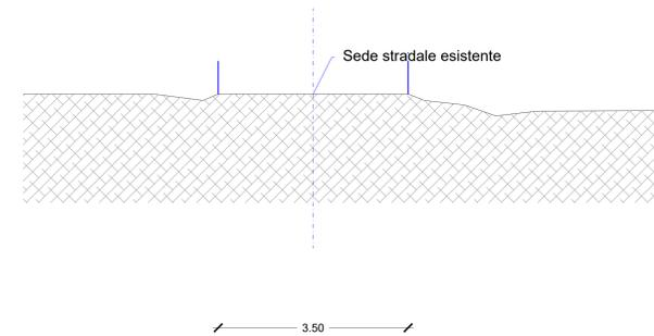
SEZIONE TIPO-ADEGUAMENTO VIABILITA' ESISTENTE\_SCALA 1:50
