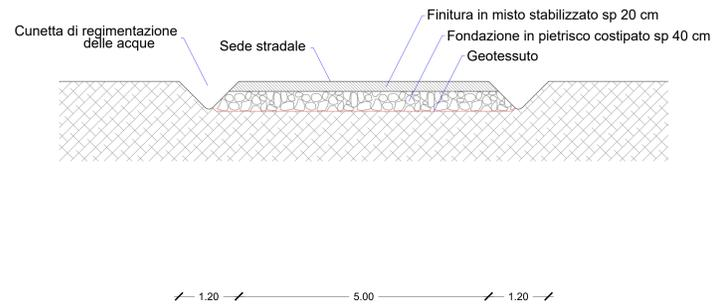
SEZIONE TIPO-SEZIONE IN RILEVATO\_SCALA 1:50
