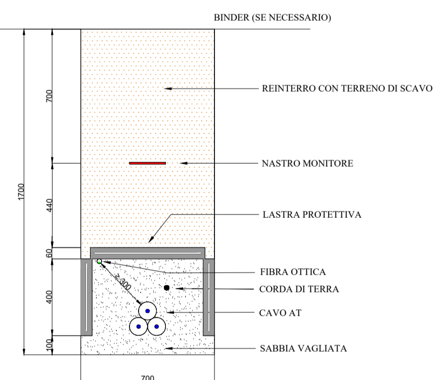
SEZIONE TIPICA CAVIDOTTO AT SU STRADA STERRATA POSA A TRIFOGLIO, 1 TERNA NELLA TRINCEA (Tutte le quote sono espresse in mm)
